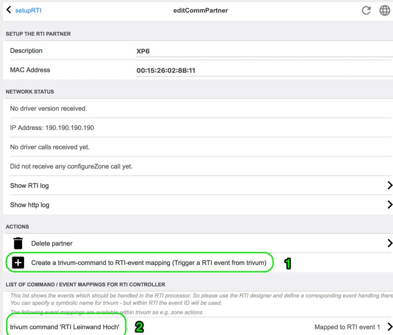
Например, экран или другое устройство, управляемое RTI, тогда программист RTI может подключить одну из 32 " из trivum сопоставленных команд " к макросу RTI. Затем этот макрос RTI реализует, например, то, что экран опускается. В системе trivum действия могут использовать в разделе процессора RTI событие с соответствующим номером.
